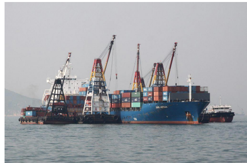
그림 3. 홍콩항에서의 컨테이너선 부선하역 모습
